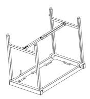
3. Установите распорку. Для этого завести конец распорки в цапфу с осью и распрямить распорку до ее фиксации пружинной защелкой. Убедитесь, что распорка надежно установлена в цапфе и защелка зафиксировала распорку.
