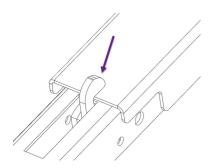
Затем сложите ножки стола и зафиксируйте их крючком. Зажмите крепежные винты крючка.
